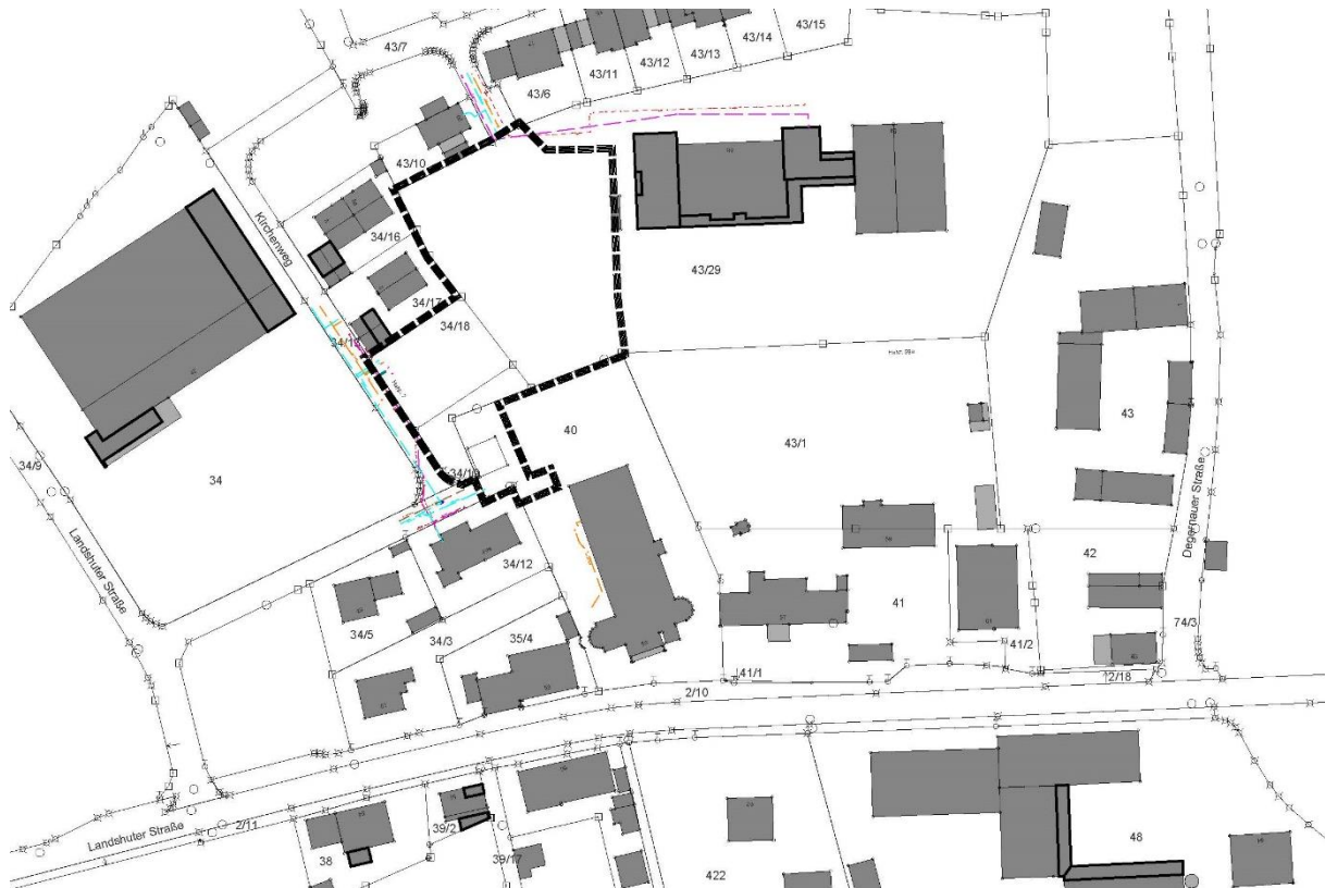
Abb.: Verlauf vorhandener Sparten: orange = Gas, magenta = Telekom, rot = Strom u. blau = Trinkwasser, lt. Spartenauskünften
